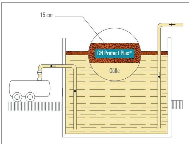
Geliefert wird per Walking-Floor- oder Silofahrzeug. Es ist daher notwendig, dass die Lieferfahrzeuge dicht an die Behälter heran fahren können. Während der Belieferung ist mit temporärer Staubentwicklung zu rechnen. Als mineralische Schwimmdecke passt sich CN Protect Plus® jederzeit automatisch der aktuellen Füllhöhe im Güllebehälter an und sichert eine kontinuierlich geschlossene Abdeckung, die sich selbst nach starken Winden oder Aufrührung sofort wieder schließt.
